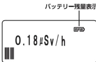
バッテリー残量表示が点滅し、表示が消えた場合は電池切れです。新品の電池と交換してください。
